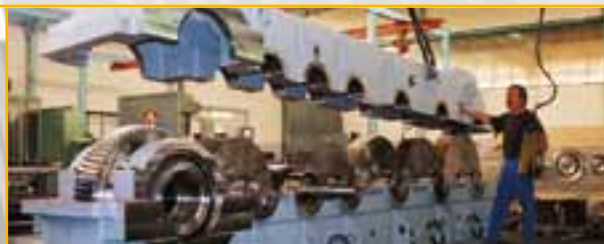
Custom-made gearbox for aluminium process with epicycloidal gear module. PECHINEY Réducteur spécial avec module épicycloïdal - PECHINEY
